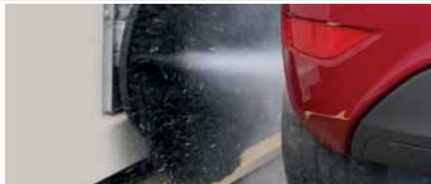
Новая ротационная система высокого давления мощностью 80 бар позволяет более тщательно промывать как наружную сторону колесных дисков, так и весь автомобиль в целом. Особенно тщательно двустороннее вращение позволяет промывать наружную сторону колесных дисков нового дизайна.
