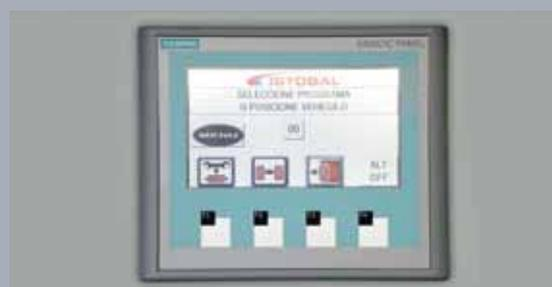
Цветной сенсорный экран нового поколения на основе функционального поста управления позволяет легче присоединять и контролировать все дополнительные приспособления на портале мойки.
