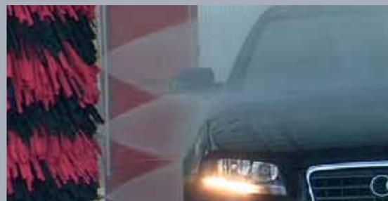
Различные предварительные опции высокого давления, которые подготавливают автомобиль к мойке щетками и тем самым улучшают результат мойки. Выбирайте из вариантов: 15 бар и 120 л/мин, 80 бар и 42 л/мин. или 80 бар и 84 л/мин.
